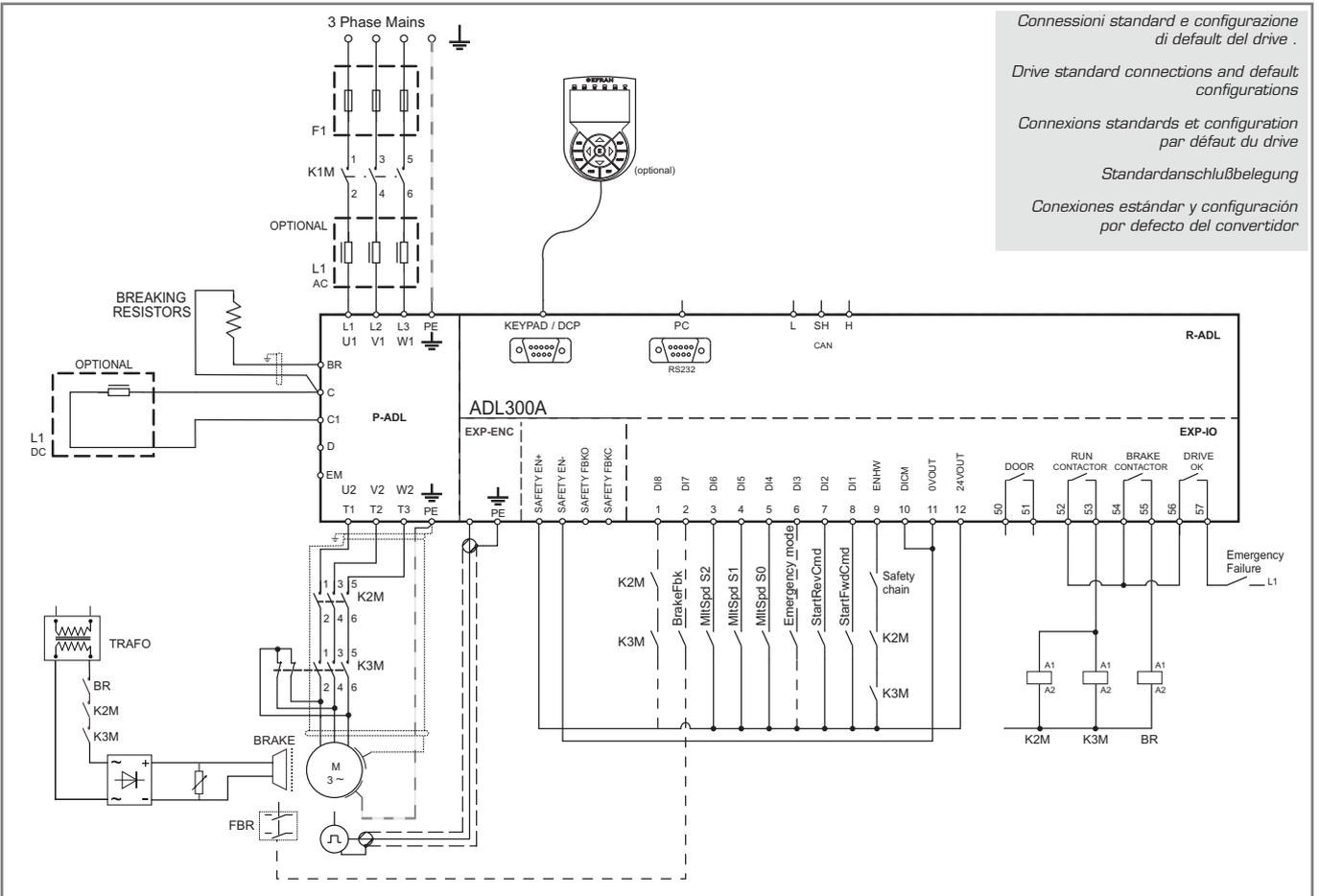
Connessioni standard e configurazione di default del drive .
