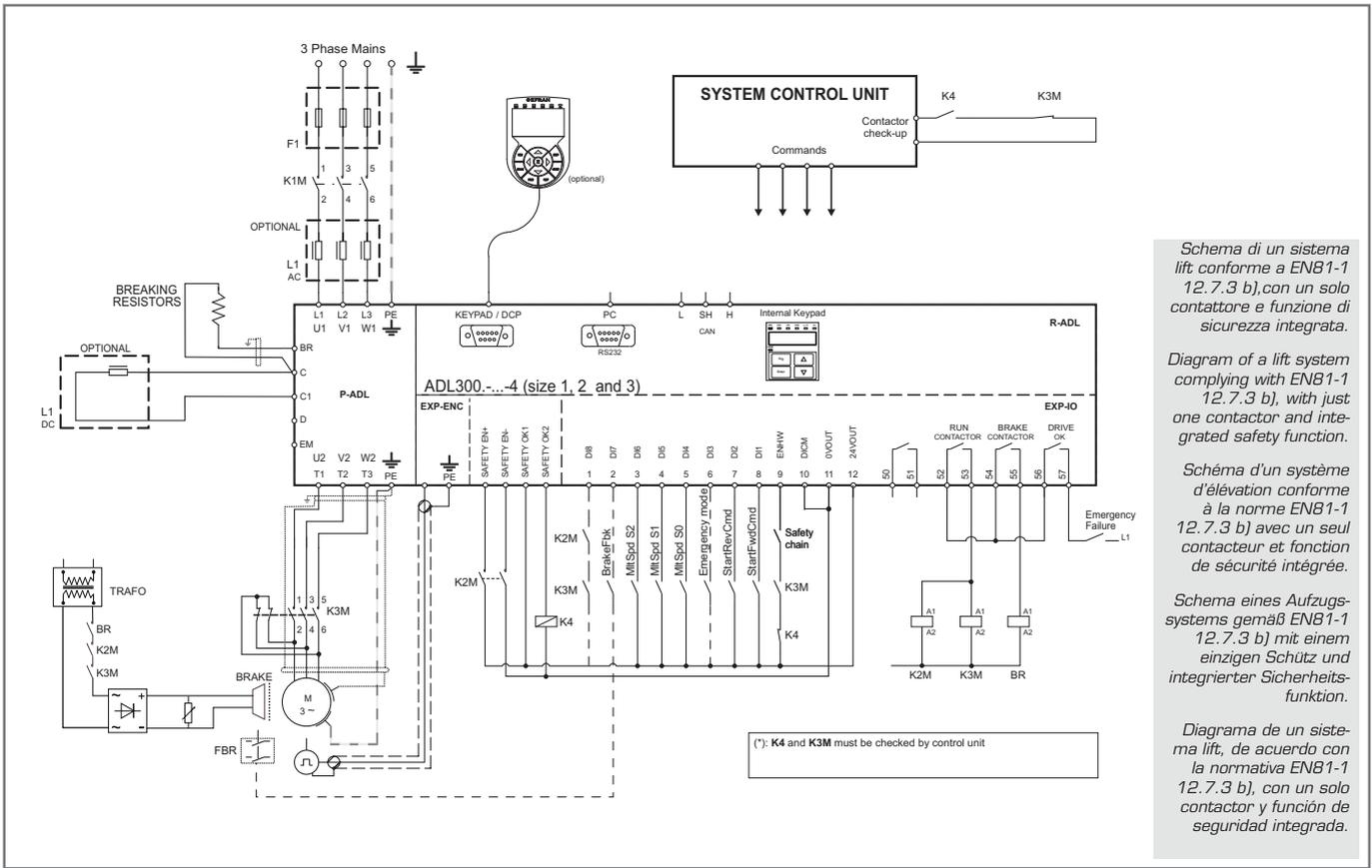
*Schema di un sistema lift conforme a EN81-1 12.7.3 b), con un solo contattore e funzione di sicurezza integrata.*
