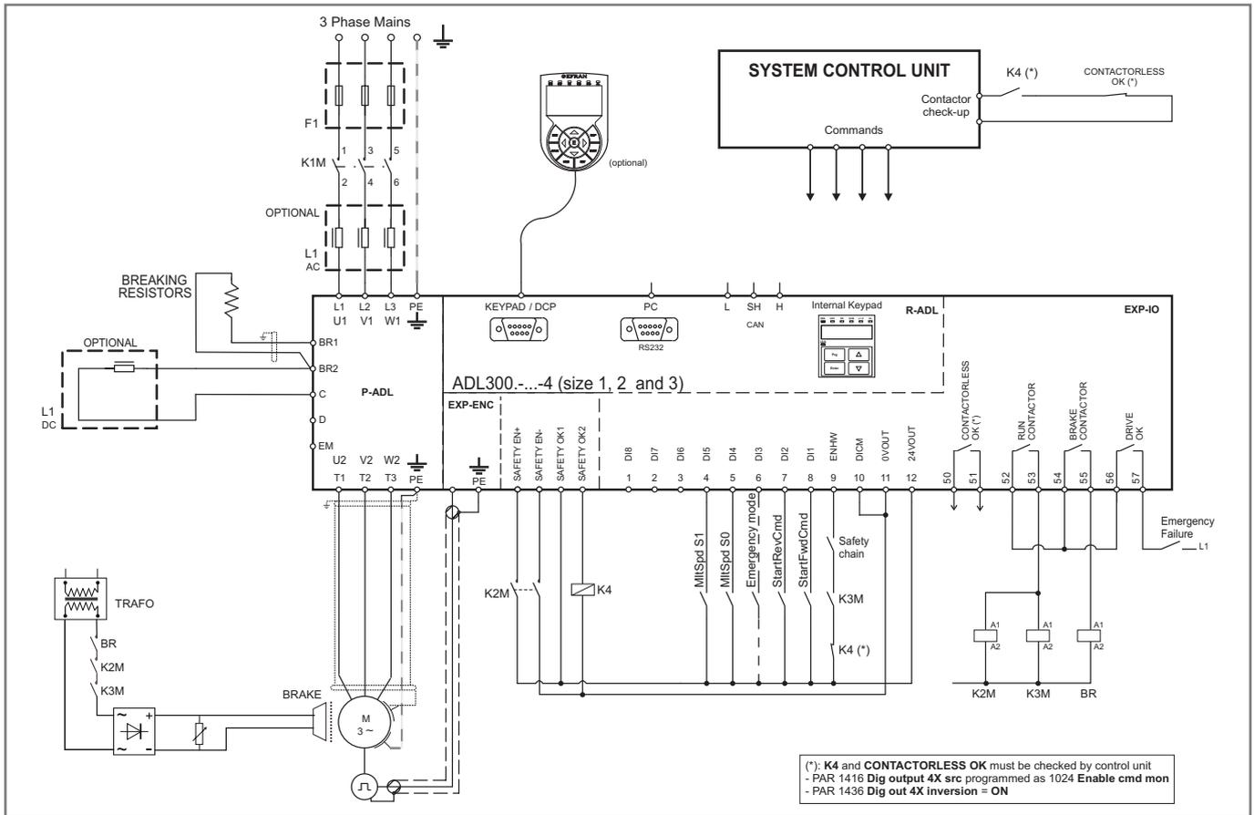
Schema di un sistema lift conforme a prEN81-20 5.9.2.5.3 d, senza utilizzo di contattori e funzione di sicurezza integrata STO (EN61800-5-2- SIL3).
